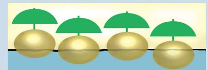
Simultanément, les molécules d'ÉTERNA® 3000 vont réagir et être fortement adsorbées sur les surfaces engendrées par la coupe. Elles vont ainsi abaisser considérablement le coefficient de frottement.
