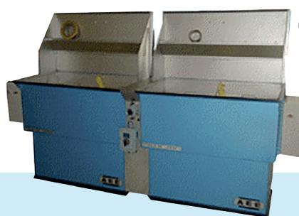
*Dégraissage de composants mécaniques en immersion, à froid ou à chaud.*
