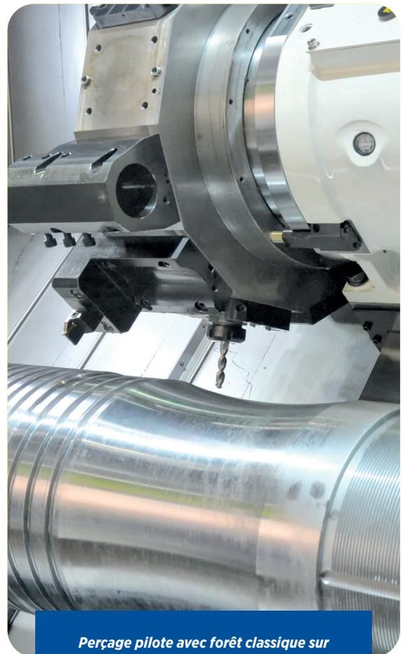
*Perçage pilote avec forêt classique sur surfaces concaves et convexes.*
