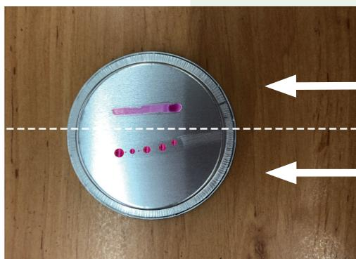
Après nettoyage, si l'encre est nette et uniforme alors cela signifie que la surface nettoyée est propre, le dégraissage est efficace.
