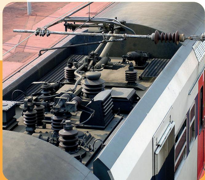
Lubrification dynamique, sous HT, de pantographes.
